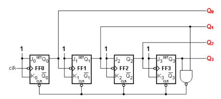
3. Construa o circuito abaixo e considere que, inicialmente, a entrada clear foi acionada, levando as saídas dos flip-flops a zero. Apresente o diagrama de estados deste contador.
